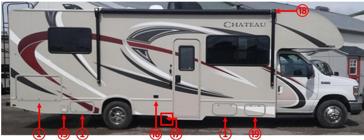
\***11** Einige Fahrzeuge sind mit einem separaten Stromanschluss anstelle des angeschlossenen Kabels ausgestattet. Das Netzkabel ist in einem Außenfach untergebracht. Siehe Abbildung unten und das Kapitel "ANSCHLUSS AN DAS NETZ (110V)!".
