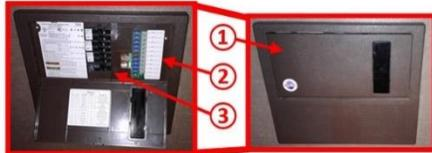
Die Sicherungen für den internen 12-Volt- bzw. 110-Volt-Stromkreis befinden sich im Sicherungskasten ①, den Sie im Schlafzimmer auf der Beifahrerseite (Rückwand des Badezimmers) finden.
