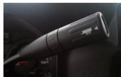
Die Tow/Haul-Funktion optimiert die Schaltleistung und verringert die Gefahr einer Überhitzung oder eines Ausfalls des Getriebes durch übermäßiges Schalten beim Fahren in bergigen Gegenden. Diese Funktion bietet zusätzliche Leistung beim Bergauffahren und Bremsunterstützung durch den Motor beim Bergabfahren, um das Risiko einer Überhitzung der Fahrzeugbremsen zu verringern. Wählen Sie diese Funktion durch Drücken der Taste im Schalthebel auf der rechten Seite des Lenkrads.
