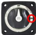
Der Hauptschalter zum Ein- und Ausschalten der Hausbatterien befindet sich direkt neben der Eingangstür auf Bodenhöhe. Dieser Schalter muss auf ON stehen, um die Geräte und den Wohnbereich mit 12-Volt-Strom zu versorgen. Wenn im Wohnbereich kein Strom vorhanden ist, überprüfen Sie immer, ob dieser Schalter versehentlich auf AUS gestellt wurde, und stellen Sie ihn gegebenenfalls wieder auf EIN.
