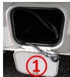
In einigen Fahrzeugen ist das Stromkabel am Fahrzeug (Aussenfach auf der Fahrerseite) angebracht ①. Andere Fahrzeuge verfügen über eine separate Verbindung ②. Das Kabel befindet sich in einem Aussenstauraum. Sichern Sie das Stromkabel ③ mit dem schwarzen Ring ④, um unbeabsichtigtes Lösen der Verbindung zu vermeiden.
