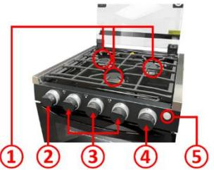
Um den OFEN anzuzünden, drücken und drehen Sie den Ofen-Bedienknopf ④ wiederholt gegen den Uhrzeigersinn, bis der Brenner brennt, und halten Sie den Knopf 5 bis 10 Sekunden lang gedrückt. Stellen Sie die Flamme durch Drehen des Bedienknopfes auf die gewünschte Stufe ein. Der Backofen verfügt über eine integrierte Beleuchtung, die mit dem Schalter ⑤ ein- und ausgeschaltet werden kann.
